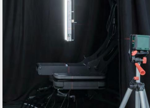
**Thermische Messungen** sind unerlässlich, um die Wärmeabfuhr der neuen Leuchte zu überprüfen. Durch diese Messungen stellen wir sicher, dass unsere Leuchten unter allen Betriebsbedingungen sicher und effizient arbeiten. Dies verhindert nicht nur Überhitzungen, sondern gewährleistet auch die Zuverlässigkeit und Langlebigkeit der Leuchten.
